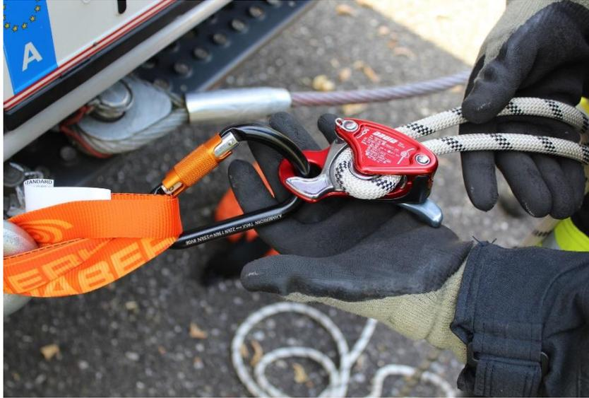
Sicherungsgerät mittels HMS-Karabiner verschließen und an einem geeigneten Anschlagpunkt befestigen.
